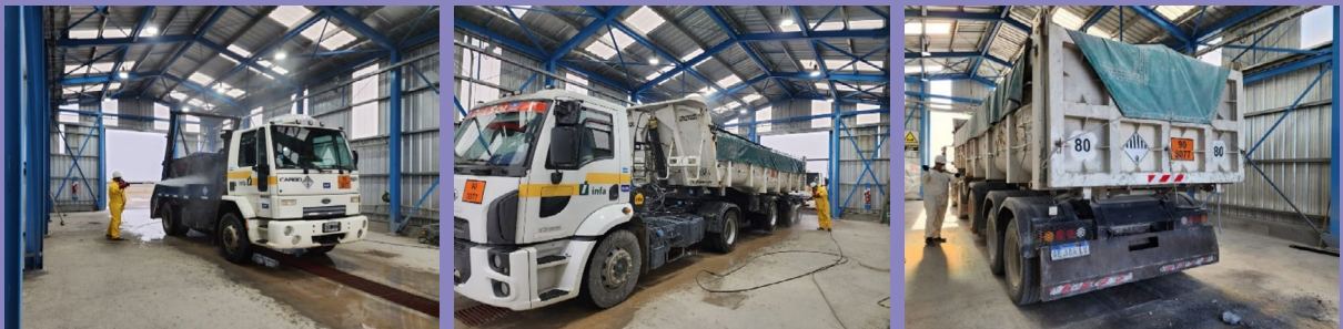
Figura 2: limpieza de los camiones bateas y portacontenedores luego de la descarga en la celda.
