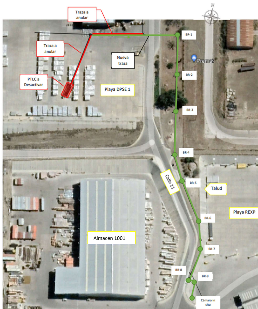
Figura 2: Proyecto de desactivación de PTLC DPS1 y construcción de cañería cloacal.
